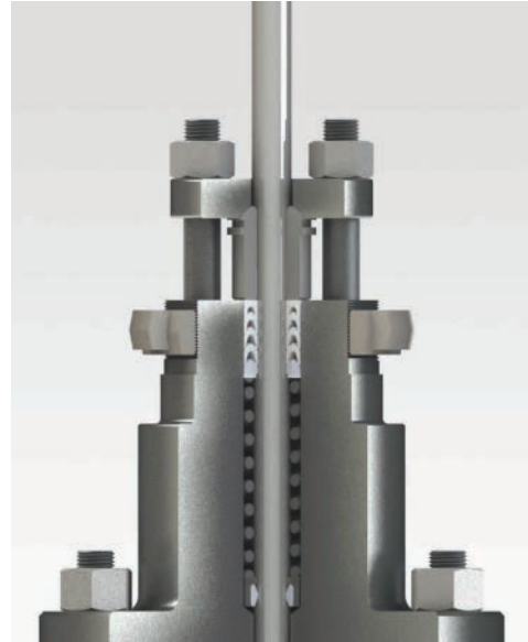
Figura 3. Dibujo de construcción del Bonete
