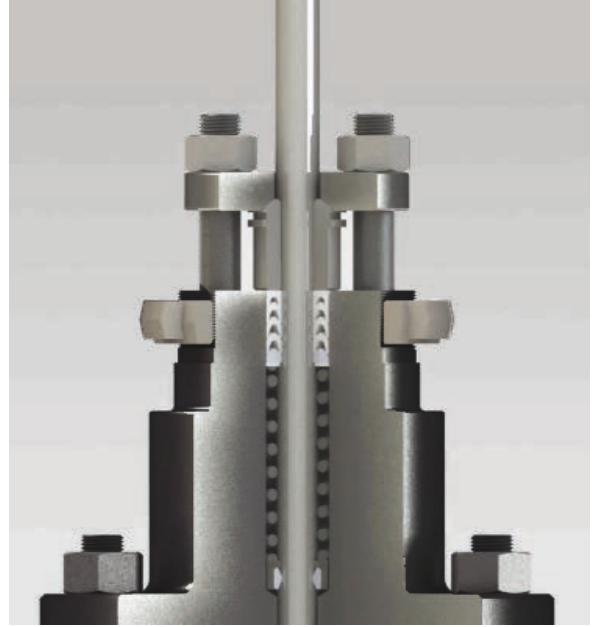
Figura 3. Dibujo de la construcción del bonete
