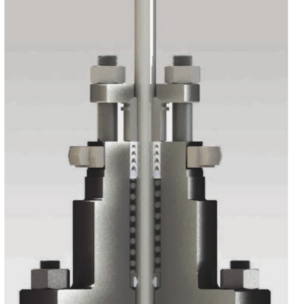
Figura 3.- Dibujo de la construcción del bonete
